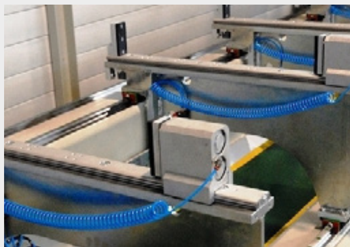
Slitta di bloccaggio pezzi per macchine di lavorazione serramenti Workpiece-locking slide for the door and window frame manufacturing industry
